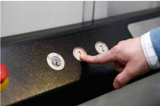
Botonera con llavín habilitador y stop de emergencia
