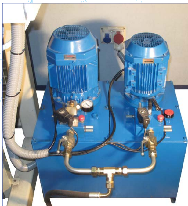
Figure 17. Centrale hydraulique.
