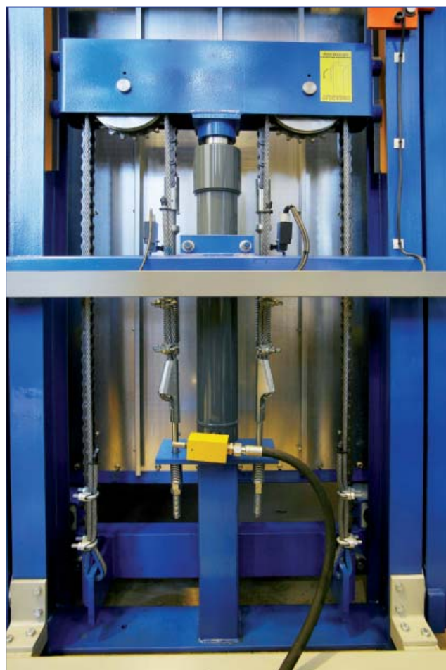
Figure 7. Vue arrière de la structure inférieure de guidage, pré-montée.
